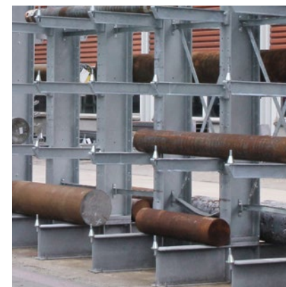
Kundenspezifische Abroll sicherung.
